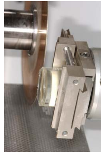
Abb. 3.3 Accutom-5 Trennmaschine von Struers mit Diamantscheibe und Wasserkühlung.
