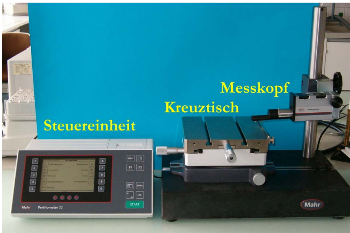
Abb. 3.14 Perthometer S2 (Mahr) zur Bestimmung der Oberflächenrauigkeit.
