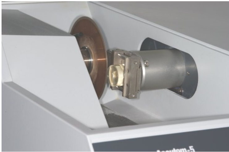
Abb. 3.3 Accutom-5 Trennmaschine von Struers mit Diamantscheibe und Wasserkühlung.
