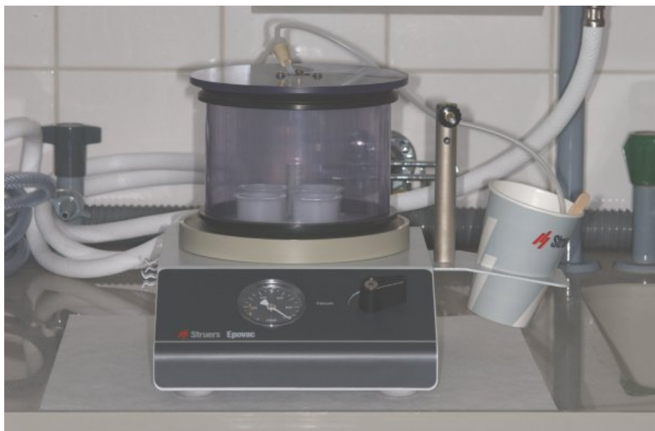
Abb. 3.2 Kalteinbettverfahren (Epovac, Struers, CH). Auf der rechten Seite ist ein Becher mit Epoxidharz zu sehen. Über einen Schlauch wird das Harz in die unter der Vakuumblocke erkennbaren Zylinder gefüllt.
